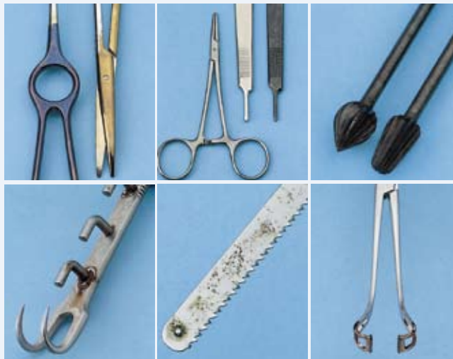
Durch unsachgemäße Aufbereitung verursachte Schäden und Belagsbildungen an chirurgischen Instrumenten.
