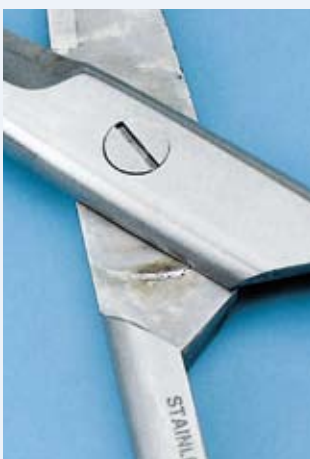
Reibkorrosion infolge fehlender Pflege mit Öl.
