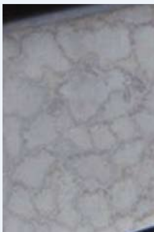
Fleckenmuster durch Verunreinigungen im Dampfkondensat.
