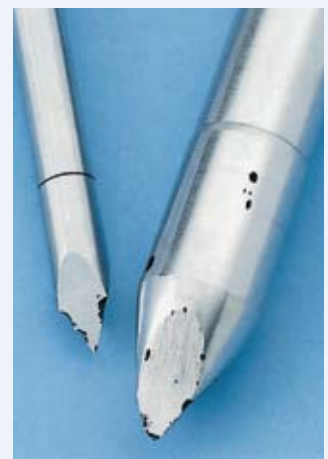
Schäden an Instrumenten aus Chromstahl.
