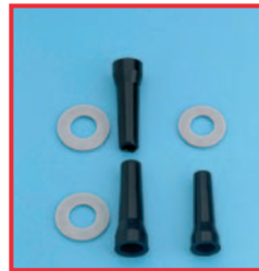
Felduzzadt tömítések helytelenül használt műszerolaj következtében.
