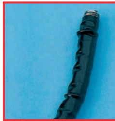
Egy bevezető cső felduzzadása nem megfelelő kezelőszer használata miatt.
