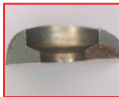
Törésfelület süllyesztett csavarfejnél
