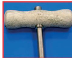
Megtámadott fémfelület csak az alumínium fogantyún Ok: erősen lúgos tisztító
