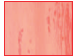
Megtámadott alumínium felület Ok: erősen lúgos tisztító
