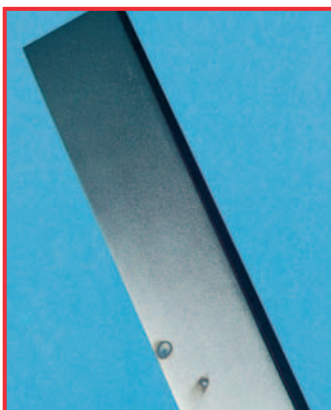
Kezdődő korrózió a véső felületén
