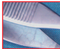
Eszköz elszíneződés foltos szélekkel
