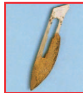
Rozsdás szikepenge Oka: egyszer használatos termék, nem rozsdamentes acél alapanyagú
