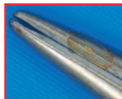
Sav okozta marás a forrasztásnál és a keményfémen mint következmény, erős kopással. Ok: túlادagolás
