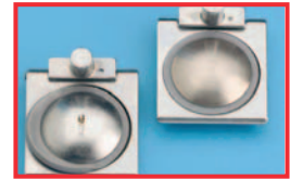
Egy trokár tömítetlen szelepe a tömítés felduzzadása miatt. Ok: olajozás
