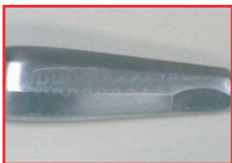
Tisztítószer okozta elváltozás nem megfelelő öblítés következtében
