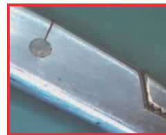
Repedés szegecselt csuklónál
