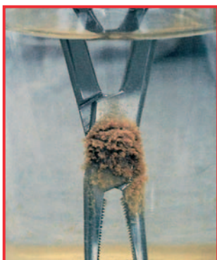
Rozsdaképződés több órás fiziológiás oldatba helyezés után
