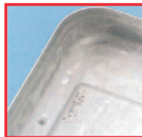
Megtámadott fémfelület. Ok: erősen lúgos tisztító
