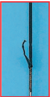
Egy NF eszköz szigetelésének sérülése
