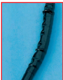
A fiberoskop disztál végének felduzzadása
