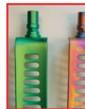
Jobb Valve: gyári, új Bal Valve: géppel tisztított, tarka elszíneződés
