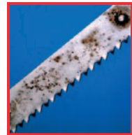
Rozsdás, krómozott fűrészlap egyszerű acélból. Oka: króm réteg hibája
