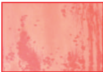
Színesre eloxált alumínium optikai elváltozása már alacsony lúgosság esetén
