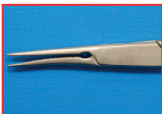
Deformálódás helytelen használat miatt
