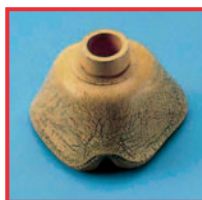
Lélegeztető maszk repedései
