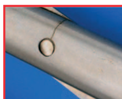
Repedés csavaros Csuklónál
