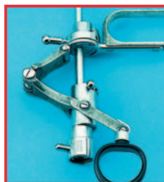
Megtámadott fémfelület csak az alumínium részeken Ok: erősen lúgos tisztító
