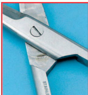
Dörzskorrózió olajozás elmaradása miatt
