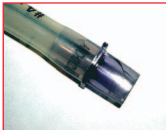
Feszültség okozta repedés
