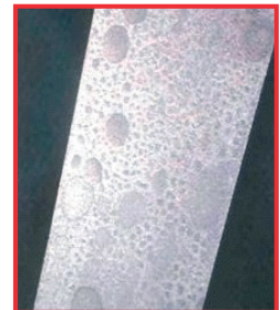
Eszköz felülete csepp formájú elszíneződéssel
