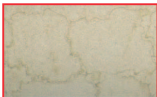
Foltosodási minta a gőz kondenzvíz vezetékeinek szennyezettsége által
