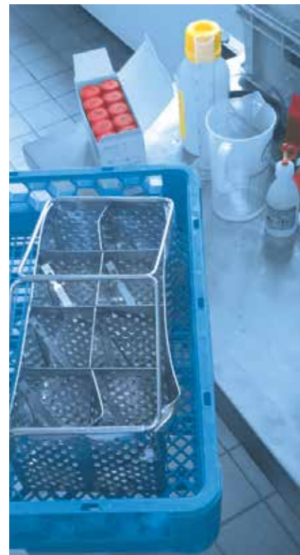
Anhand des mit Bioindikatoren beladenen Besteckkorbes wird das Spülergebnis der Geschirrspülmaschine überprüft.
