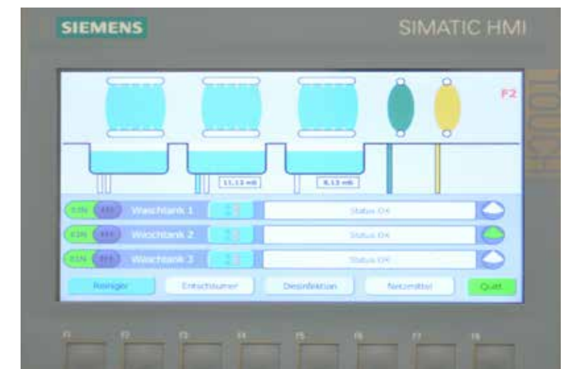
Abb. 2: Siemens Touch Panel für die Chemikaliendosierung für die Kistenwaschanlage. Auf dem Display sieht man gerade die Additivdosierung für die Kistenwaschanlage.
