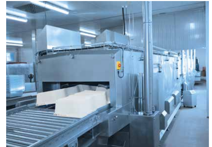
Abb. 1: Die Transportkisten werden durch die Kistenwaschanlage von Kitzinger gefahren. Hier werden sie gewaschen und anschließend mit Heißluft trocken geblasen. Zum Schluss werden die Kisten manuell gestapelt und sind dann wieder einsatzbereit.
