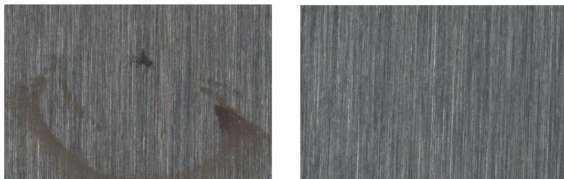
Der Laborversuch belegt die Wirkung: Die Aufnahme links zeigt die Instrumenten-Oberfläche, auf die 6 Std. Kochsalzlösung (NaCl-Lösung) eingewirkt hat; die Aufnahme rechts die Oberfläche, auf die eine Kombination von neodisher® PreStop und NaCl-Lösung gleicher Konzentration 6 Std. eingewirkt hat.
