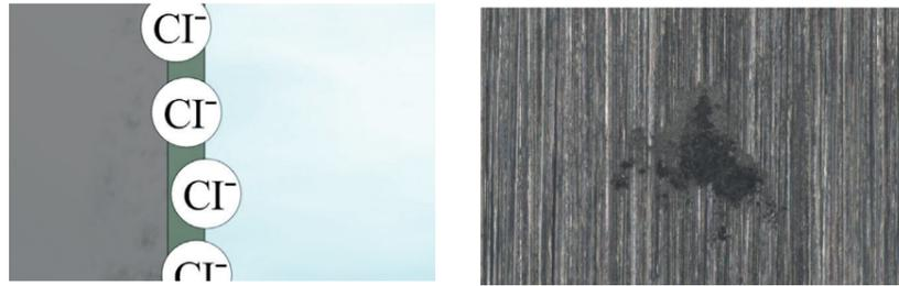
Das Schaubild (oben links) zeigt vereinfacht die Korrosionsentstehung durch Chlorid-Ionen, die z.B. im Blut oder physiologischer Kochsalzlösung (NaCl-Lösung) enthalten sind. Die Chlorid-Ionen greifen die Chromoxid-Schicht des Instrumentenstahls an, die diesen vor Korrosion schützt. So entstehen kleine Löcher an der Stahl-Oberfläche. Diese Schäden sind irreparabel.
