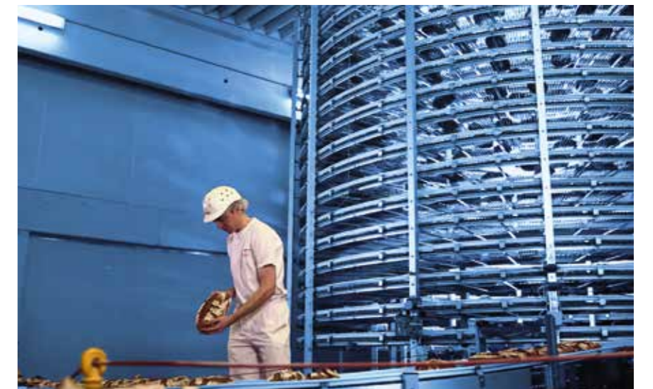
In den neun Großbäckereien backt moderne Technik: die Teigzubereitung und das Fahren der Brotlaibe durch die Backöfen sind computergesteuert. Das Verpacken läuft vollautomatisch. Hier gewährleistet die Technologie Qualität, Hygiene und Produktsicherheit
