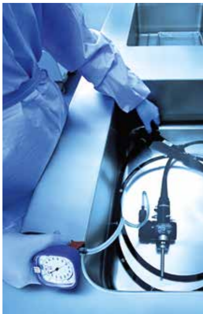
Dichtheitstest eines flexiblen Endoskopes als Bestandteil der Aufbereitung
