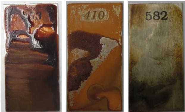
Abbildung 4: Beispielhafte Anschmutzungen auf Edelstahlplättchen – vor dem Reinigungsversuch
