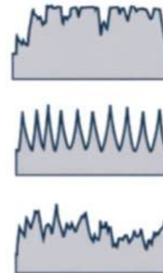
Unterschiedliche Oberflächenstrukturen bei gleichem Rauigkeitswert ( Ra=2,4 \mu m )
