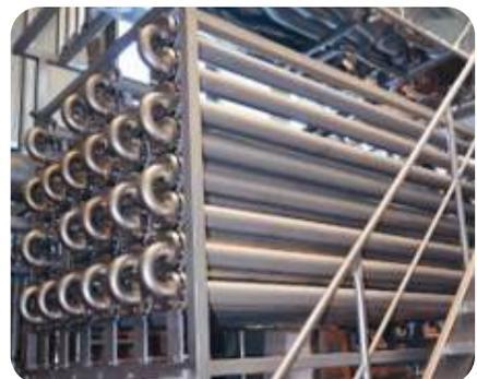
Mehrstufige Filtration des Saftkonzentrats
