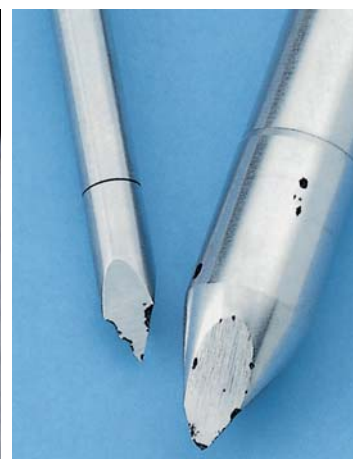
Krómacél műszereken keletkezett károk.
