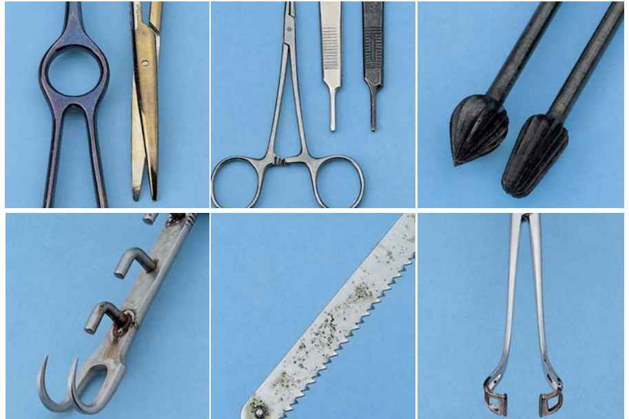
Nem megfelelő tisztítás miatt kialakult károk és bevonatok sebészeti műszereken.
