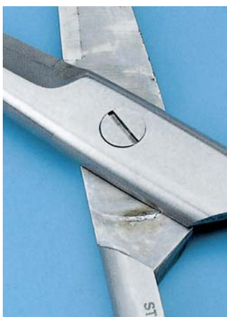
Súrlódás okozta korrózió, az olajozás hiánya miatt.
