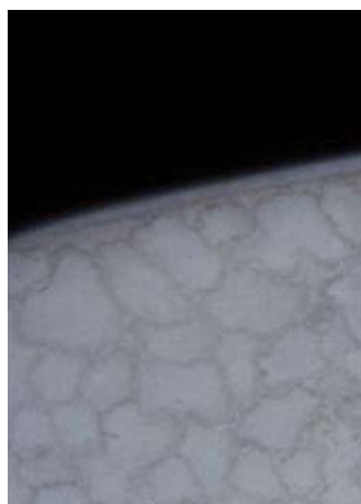
Foltszerű minták a gőzkondenzátum szennyeződése következtében.
