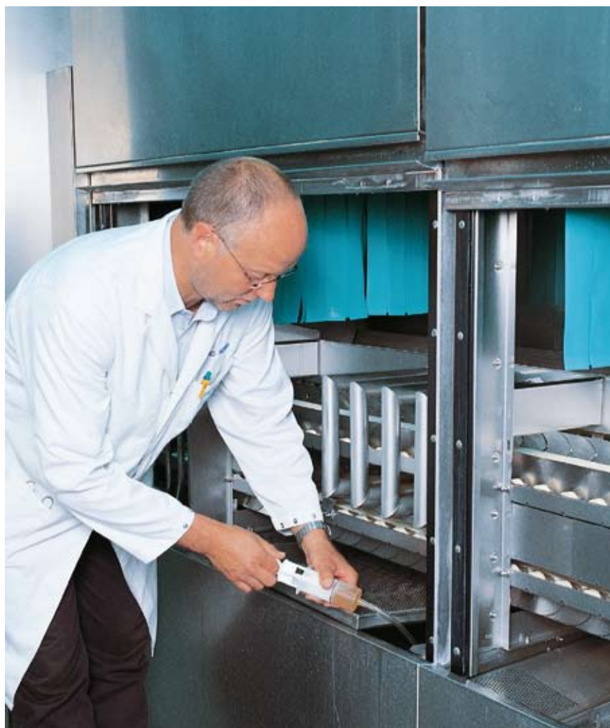
Kontrolle der Spülflotte einer Bandspülmaschine
