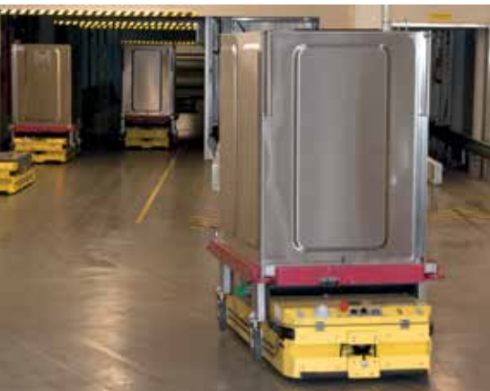
Huckepack: Carobots transportieren mit bis zu 10 km/h die Krankenhauscontainer
