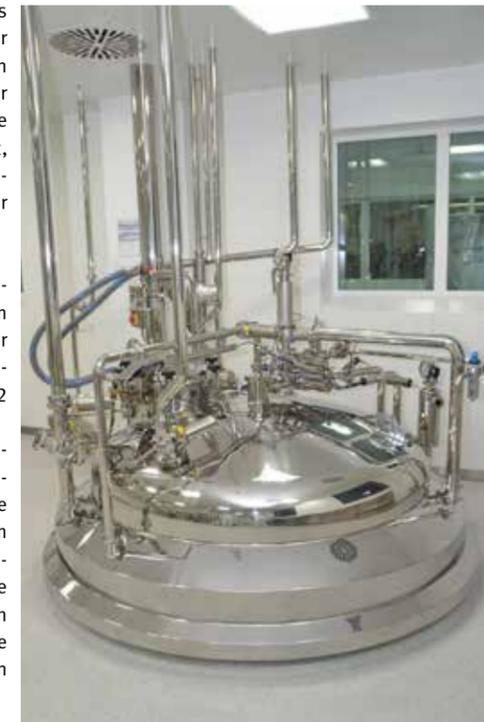
**Der tonnenschwere Salbenmischer befindet sich im Innenhof zwischen EG und 1. OG. Aufgestellt wurde er durch das Dach mit Hilfe eines Autokrans**
