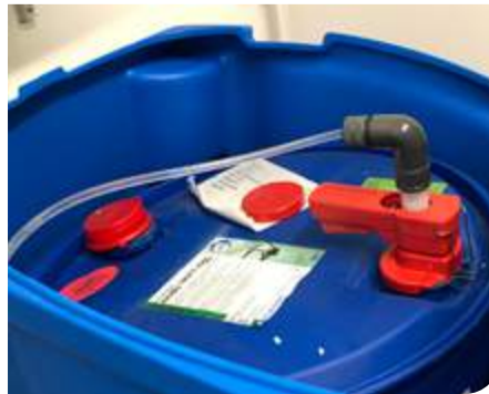
Abb. 2: Ein sogenannter KEG-Verschluss öffnet das Desinfektionsmittelfass, so dass der Bediener zu keinem Zeitpunkt mit einem offenen Fass arbeitet.
