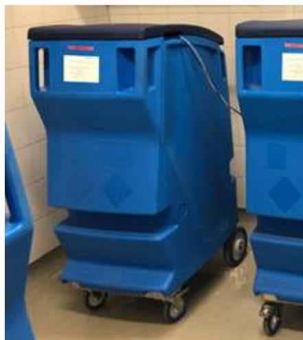
Abb. 3: Drumtainer erlauben einfaches Bewegen der Chemikalienfässer und dienen als Auffangwanne.
