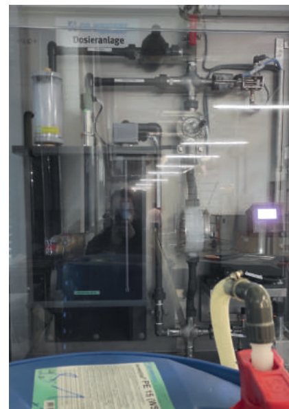
Dosieranlage für Peressigsäure-Produkte mit besonderen Sicherheitsvorrichtungen
