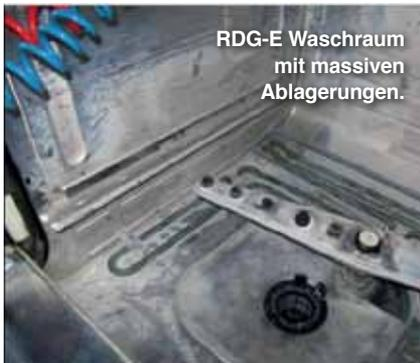
RDG-E Waschraum mit massiven Ablagerungen.
