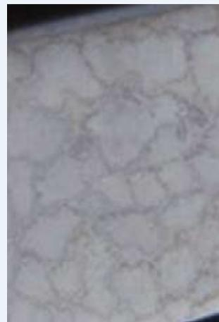
**Fleckenmuster durch Verunreinigungen im Dampfkondensat.**
