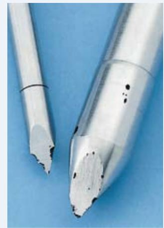
**Schäden an Instrumenten aus Chromstahl.**
