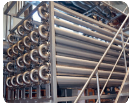
Filtration mult niveau du concentré de jus de fruits
