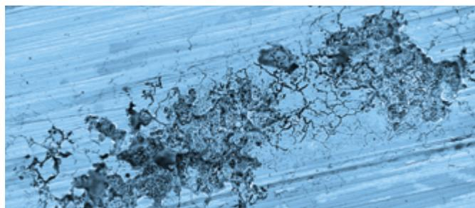
Schäden durch chloridinduzierte Lochkorrosion auf Instrumentenstahl sind irreparabel
