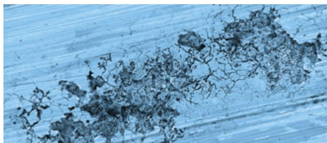
Les dommages provoqués par les piqûres de corrosion sur les instruments en acier inoxydable sont préjudiciables
