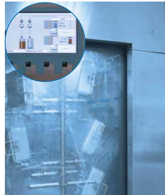
**Inbetriebnahme der Containerwaschanlage (CWA) mit enzymatischen Universalreiniger neodisher® MediClean forte und neodisher® MediKlar. Im Rahmen der Validierung wurde eine Proteinanschmutzung von 0 µg an den Prüfkörpern in 6 von 8 Reinigungsläufen detektiert.**
