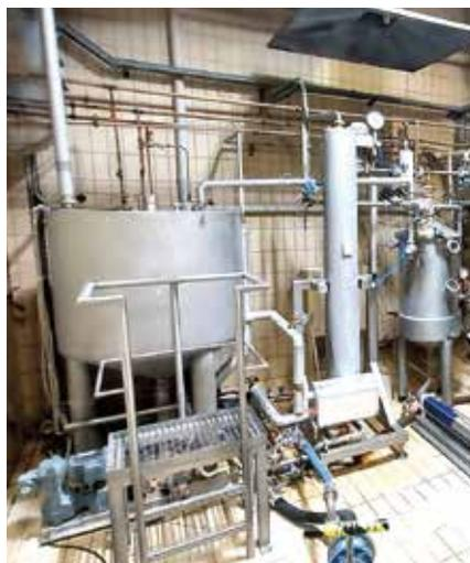
Die Massekocher für Gummibären und Co.: Mussten sie früher zur Grundreinigung aufwändig auseinandergebaut werden, kann das dank Verfahrensänderung und Produktoptimierung entfallen
