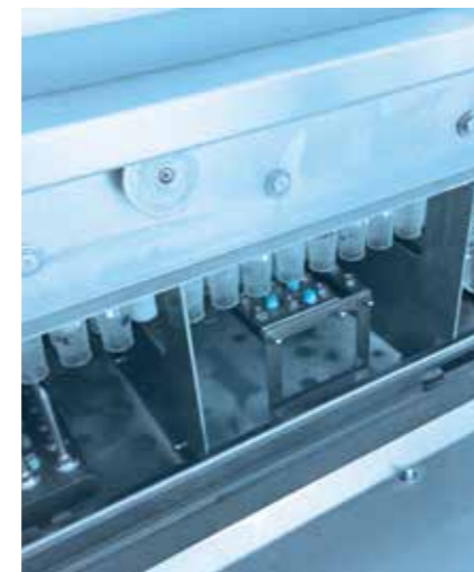
Die Flaschenwaschanlage der Firma Bartec sorgt unter Einsatz von neodisher® Produkten für rückstandsfreie Sauberkeit. Die Röhrchen werden automatisch aus den runden Transportbehältern entnommen, entleert und mit Hilfe exakt positionierter Düsen gereinigt.
