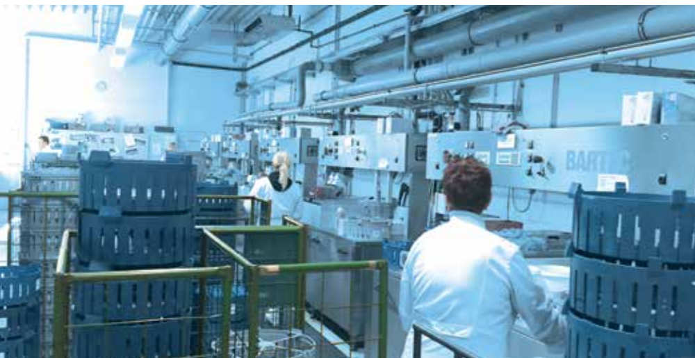
Die Flaschenwaschanlage der Firma Bartec sorgt unter Einsatz von neodisher® Produkten für rückstandsfreie Sauberkeit. Die Röhrchen werden automatisch aus den runden Transportbehältern entnommen, entleert und mit Hilfe exakt positionierter Düsen gereinigt.
