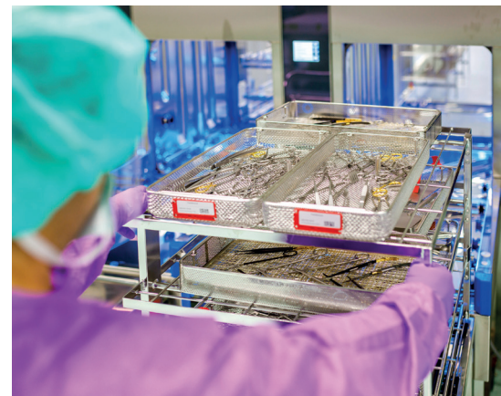
Einschub in die Maschine: auf der unreinen Seite erfolgt nach der Vorbehandlung die maschinelle Reinigung in einem der 10 RDG
