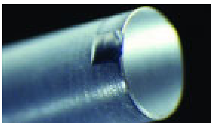
2. ábra: Termikus lencsekárosodás
